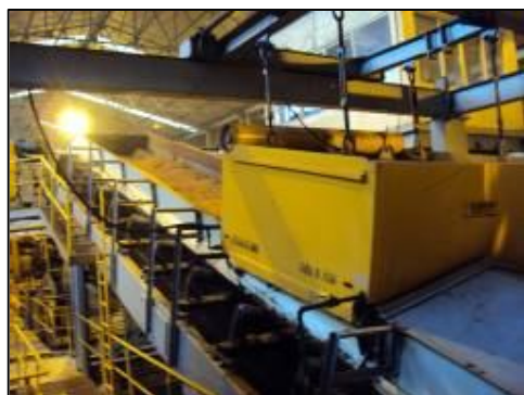
12 - Eletrodinâmico para retirada de possíveis metais misturados na cana.
