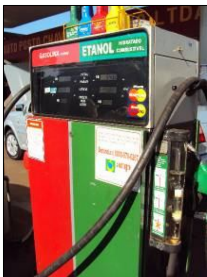
Figura 42 – densímetro acoplado à bomba de combustível.
