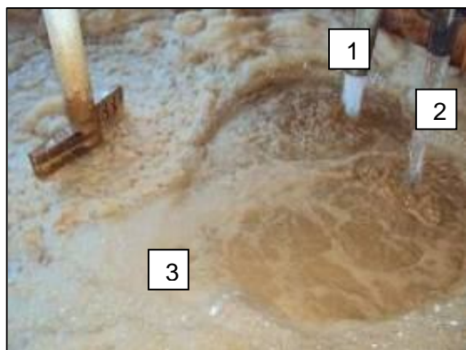
Figura 29 - tratamento da levedura com o Ácido e a água.
