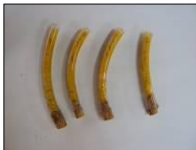
Figura 50 – tubos com fragmentos de giz tratados com dicromato de potássio.
