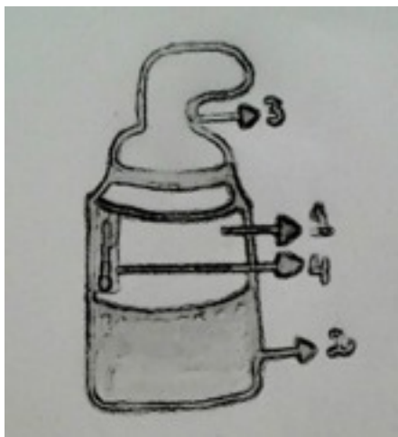
Legenda: 1- vidro de alimento, 2- composto, 3- bexiga, 4- termômetro.
