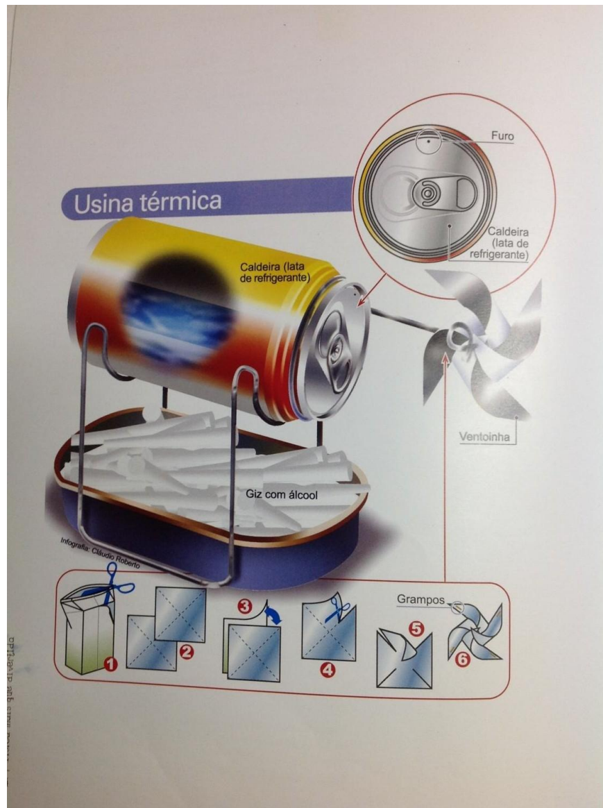
Figura 1 – Dispositivo experimental da Usina Térmica
