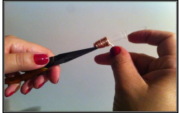
Figura 2: Construção do cone
