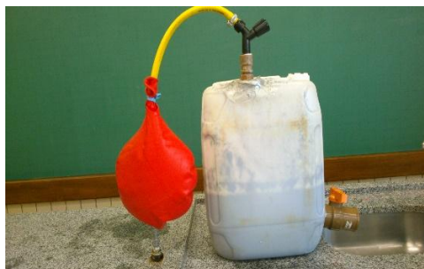
Imagem 1 – Modelo protótipo 5 com dejetos suínos e inoculante – Imagem do próprio autor
