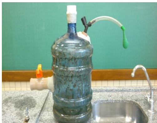
Imagem 4 – Modelo do protótipo com dejetos bovinos – Imagem do próprio autor
