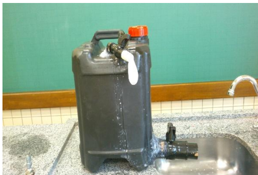
Imagem 3 – Modelo do protótipo com dejetos suínos – Imagem do próprio autor
