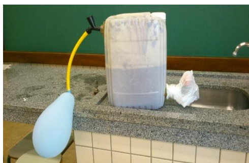
Imagem 2 – Modelo do protótipo com dejetos de aves – Imagem do próprio autor
