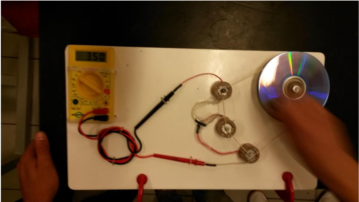
Figura 2 – Esquema de montagem de um gerador manual.
