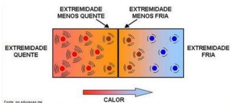
Figura 3 – Representação do fluxo de calor
