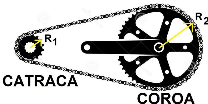
Figura 12: Mecanismo de transmissão atualmente utilizado nas bicicletas.
