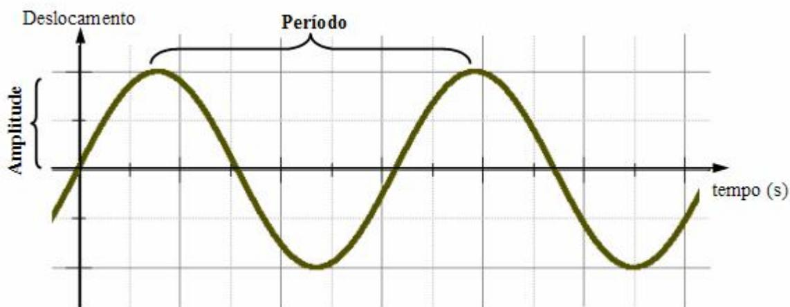
Fig. 15. Amplitude, Frequência e Período
