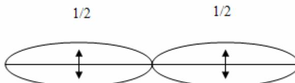
Fig. 16. Vibração da corda pressionada na metade
