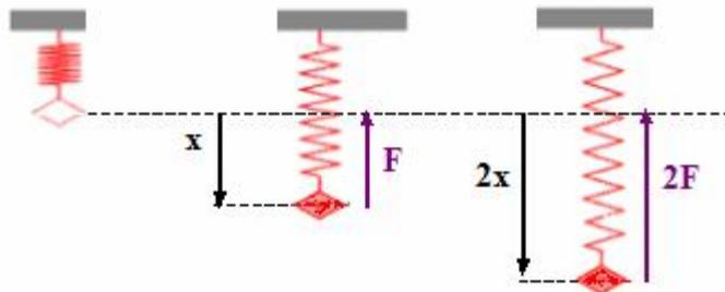
Fig. 04 – Sistema Massa-Mola - Lei de Hooke
