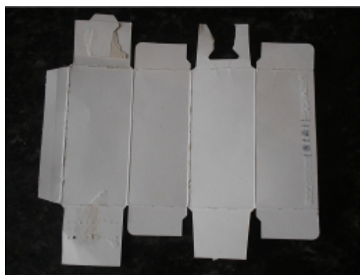
Figura 2.12 – planificação da caixa de medicamento
