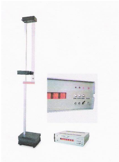
À esquerda equipamento para avaliação do tempo de reação. À direita esquema do equipamento
